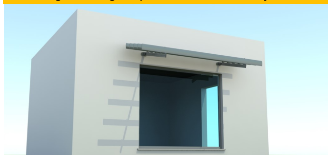
Seguir montagem tipo B75/15 rodando o conjunto
