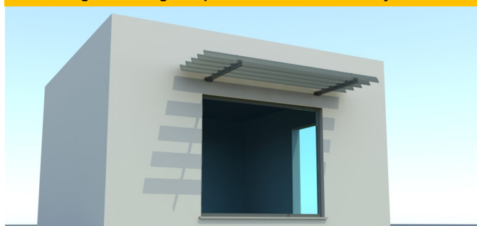
Seguir montagem tipo B90/30 rodando o conjunto
